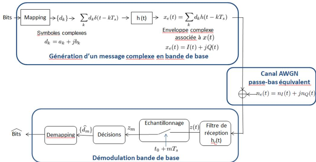
Figure 2: Chaîne de transmission passe-bas équivalente
