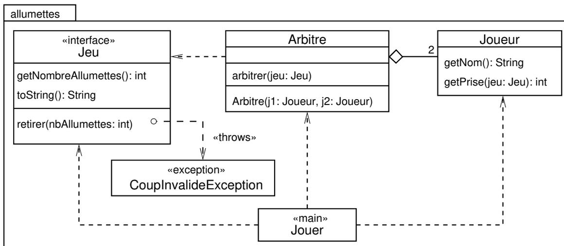
FIGURE 1 – Diagramme de classe d'analyse pour le jeu des 13 allumettes
