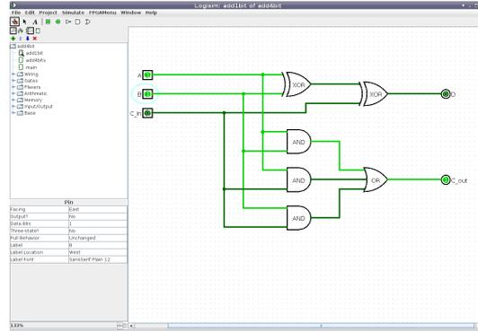
Ce projet vise à créer un programme permettant de simuler un circuit logique dont la construction se ferait graphiquement. Dans le style de Logisim [5] l'utilisateur aurait à sa disposition une boîte à outil pour poser des portes logiques et un outil pour tracer les liaisons.
